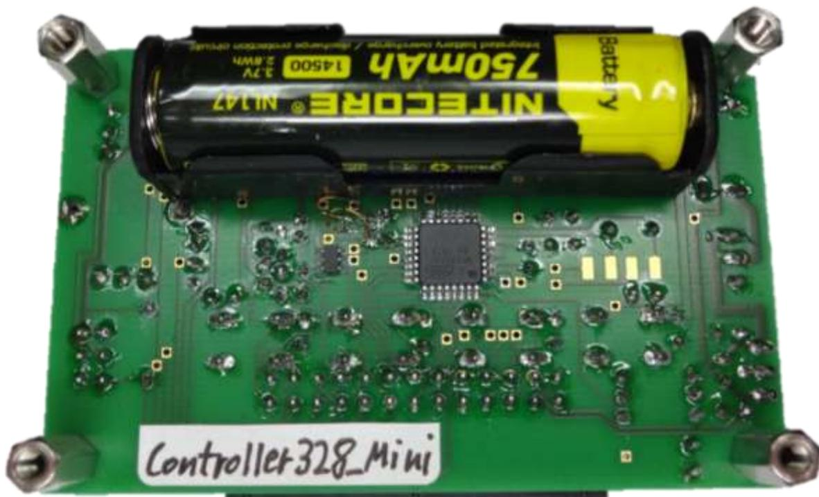
Bild 15: Rückseite mit ATMega328 und DAC
