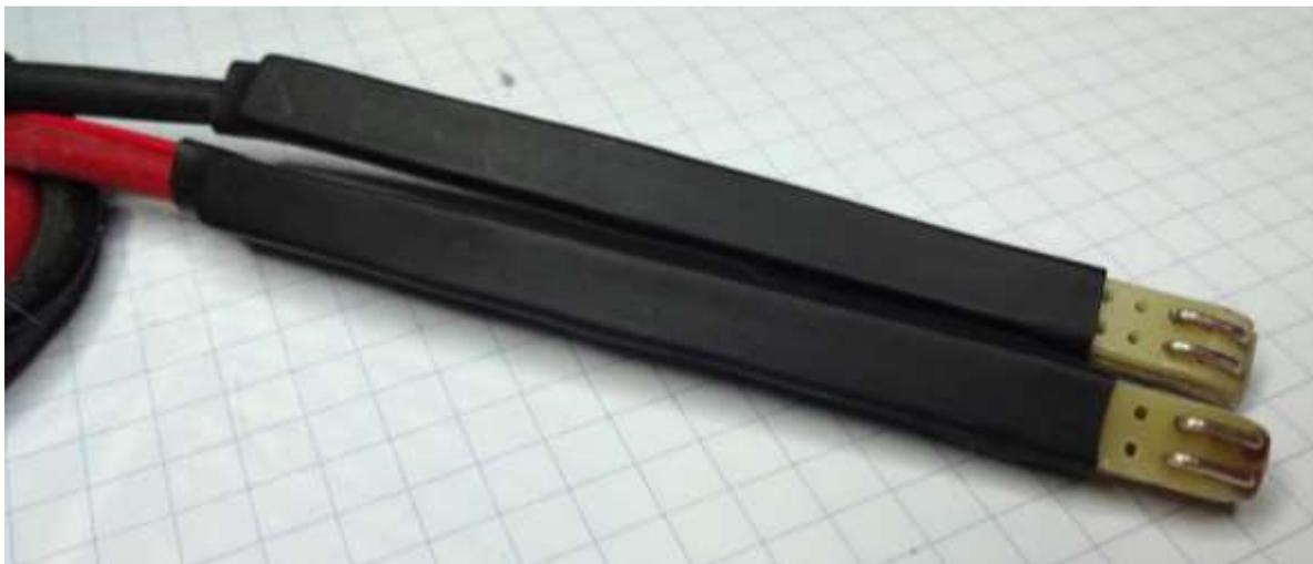
Bild 19: Das fertige Prüfspitzenpaar
